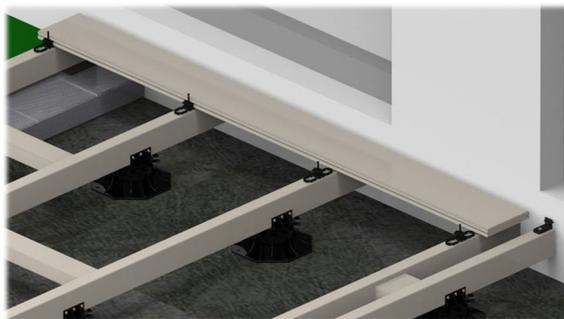
Figure 16 : Première lame. Ne vissez pas les clips de fixation avant d'avoir correctement placé la lame suivante.
