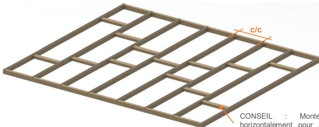
CONSEIL : Monter les traverses horizontalement pour assurer une bonne ventilation et un bon drainage.
